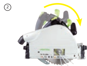
② Die Hände sind jetzt frei. Die Schraube einfach mit dem Inbusschlüssel öffnen und das Sägeblatt heraus nehmen.
