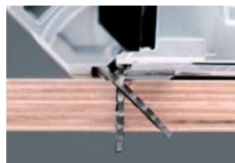
Anrisskante ist gleich Schnittkante, auch bei Winkelschnitten.
