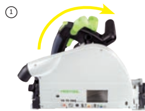
① Den FastFix Hebel öffnen, die Maschine wie beim Eintauchen nach unten drücken bis sie hörbar einrastet. Der Spindelstopp ist aktiviert.
