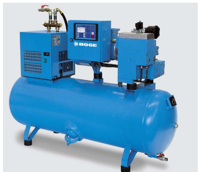
Direkt gekuppelte Schraubenkompressoren ohne Keilriemen, ohne Getriebe. Kompressor und Motor sind direkt über eine Kupplung miteinander verbunden, so daß keine Übertragungsverluste entstehen.
